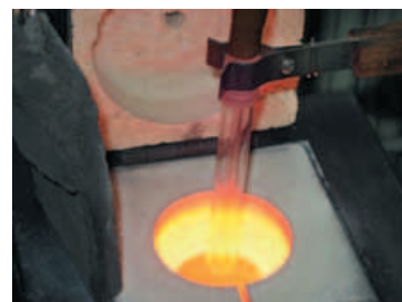
Trempage dans le verre sensible en fusion
