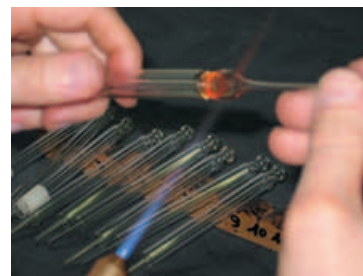
Préparation de l'ébauche pour trempage
