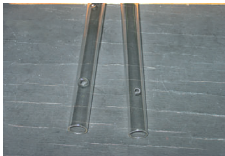
Photo 2 : résultat du flambage sur l'orifice de remplissage : avant (à dr.), après (à g.)
