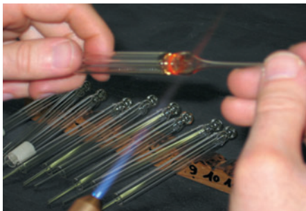
Photos 6 et 7 : préparation de l'ébauche pour trempage
